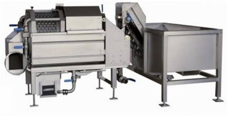
Figuur 1 - Voorbeeld van een spoelsorteermachine met opvangbak en opvoerband.
