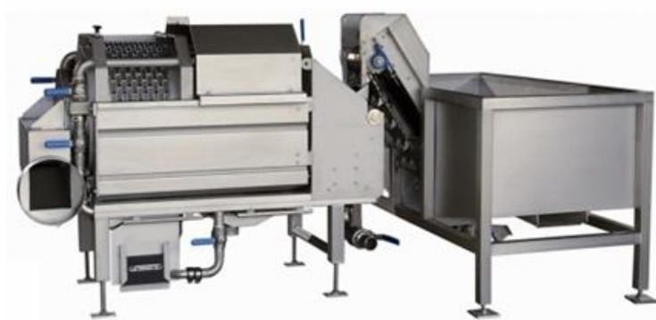
Figuur 1. Voorbeeld van een spoelsorteermachine met opvangbak en opvoerband.
